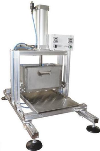
МТК-50К(М) предназначена для формирования заготовок сбивных кондитерских масс таких как зефир, миндальное, заварное, бисквитное печенье, а также безе, суфле, и т.д.. В данной машине возможно формирование легких, сбивных и текучих масс за счет того, что в форсунке встроен пневмопережим, который позволяет регулировать истечение массы на лоток. Диаметр заготовок регулируется за счет времени давления, а высота изделия регулируется за счет высоты подъема столешницы.
