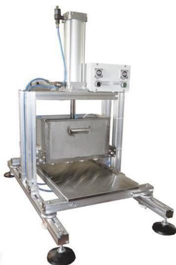
Одна из кассет МТК-50К предназначена для формирования заготовок сбивных кондитерских масс таких как зефир, миндальное, заварное, бисквитное печенье, а также безе, суфле, и т.д.. В данной машине возможно формирование легких, сбивных и текучих масс за счет того, что в форсунке встроен пневмопережим, который позволяет регулировать истечение массы на лоток. Диаметр заготовок регулируется за счет времени давления, а высота изделия регулируется за счет высоты подъема столешницы.
